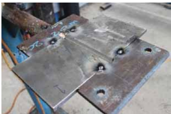
ภาพ 2 การเตรียมงานก่อนการเชื่อม
