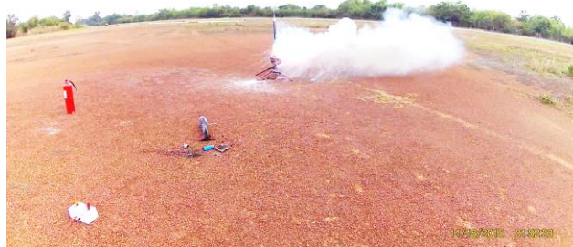
รูปที่ 14 การทดสอบยิงจรวดคลาสไอและเจเกิดการเผาไหม้แต่ยังไม่ขึ้นรูปแบบเชื้อเพลิงรูปทรงกระบอกตัน
