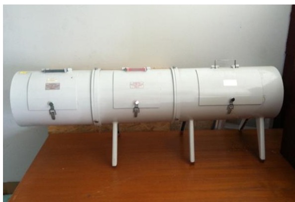
ภาพที่ 7 ถังยิงเก็บปลอก, หัวกระสุน ชนิดบรรจุ Kevlar fibers
