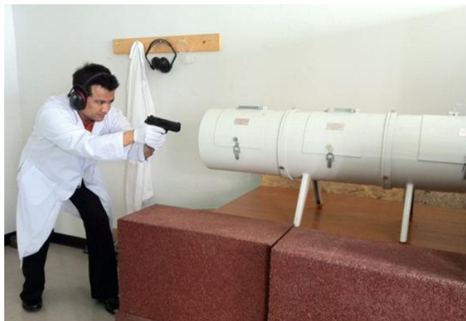
ภาพที่ 8 ตัวอย่างการยิงปืนเข้าถึงชนิดบรรจุ Kevlar fibers
