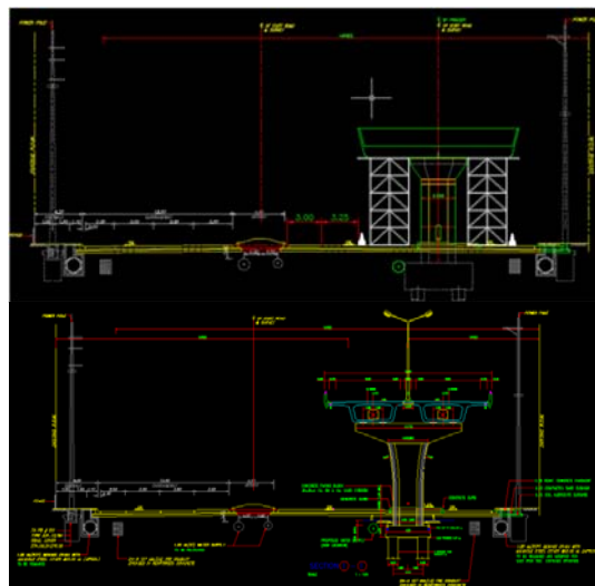
รูปที่ 3 ภาพแสดงเปรียบเทียบขนาดโครงสร้างก่อนและหลังการปรับปรุงแบบก่อสร้าง
