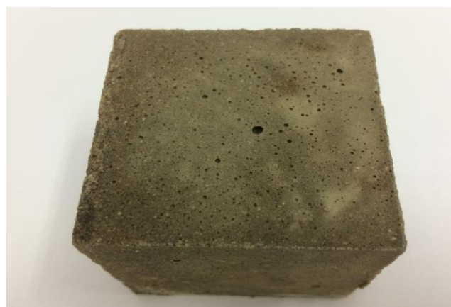
(5-a) ตัวอย่างจีโอโพลิเมอร์มอร์ตาร์บ่มอุณหภูมิห้องที่ไม่ใช่สารละลายแมกนีเซียมซัลเฟต
