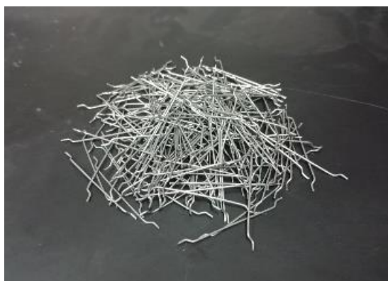
รูปที่ 1 แสดงเส้นใยเหล็ก (Steel fiber, SF)
