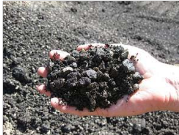
รูปที่ 3 วัสดุผิวทางที่นำกลับมาใช้ใหม่ (RAP)
