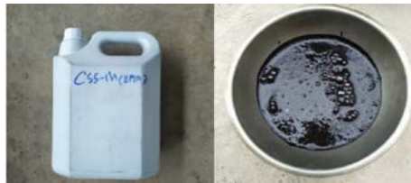
รูปที่ 8 ยางพาราแอสฟัลต์อีมีลชัน CSS - 1h (EMA)
