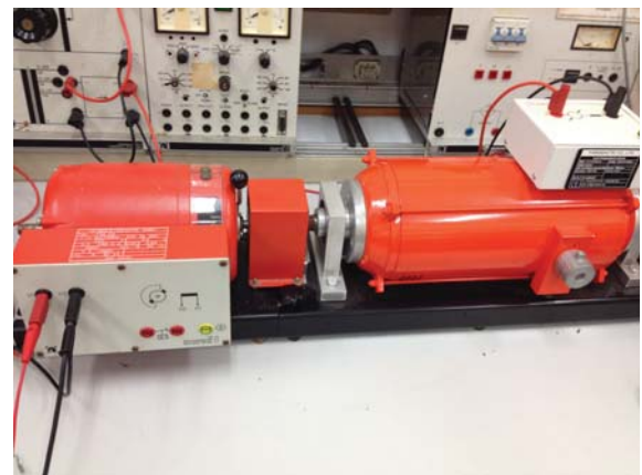
รูปที่ 16 โหลดอินดักชันมอเตอร์ขนาดพิกัด 0.3 kW
