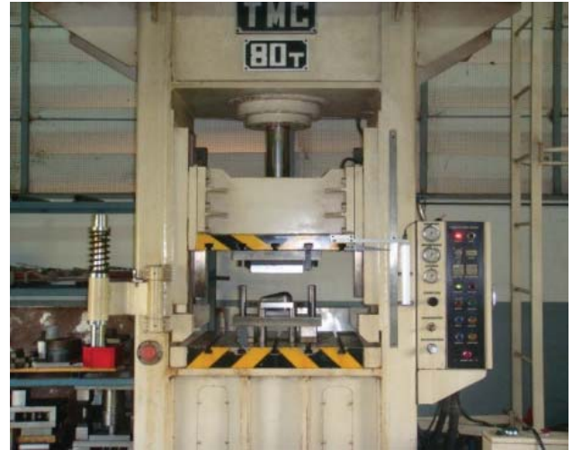
รูปที่ 4 การติดตั้งแม่พิมพ์บนเครื่องบีบไฮดรอลิกส์ 80 ตัน
