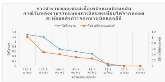
ภาพที่ 13 อธิบายการทำงานของเซลล์เชื้อเพลิงแบบป้อนกลับโดยเปรียบเทียบค่าความเข้มแสงเฉลี่ยระหว่างการทดลองกับการแยกน้ำเพื่อให้ได้ไฮโดรเจน และนำไปใช้กับโหลดมอเตอร์ไฟฟ้ากระแสตรง
