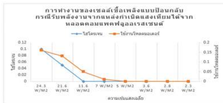
ภาพที่ 15 อธิบายการทำงานของเซลล์เชื้อเพลิงแบบป้อนกลับโดยเปรียบเทียบค่าความเข้มแสงเฉลี่ยระหว่างการทดลองกับการแยกน้ำเพื่อให้ได้ไฮโดรเจน และนำไปใช้กับหลอดมอเตอร์ไฟฟ้ากระแสตรง
