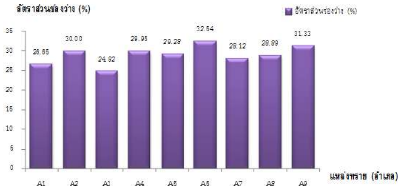
ภาพที่ 3 แสดงผลการทดสอบการหาช่องว่างระหว่างมวลรวมของทราย ทั้ง 9 แหล่ง
