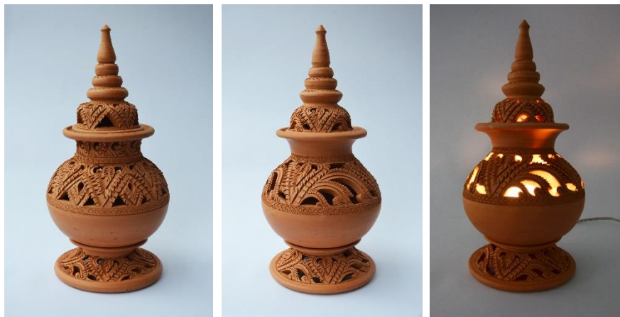
ภาพที่ 4 ชิ้นงานที่ผ่านการเผาแล้วที่อุณหภูมิ 850 องศาเซลเซียส
