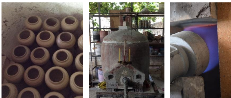
ภาพที่ 2 การทดสอบการเผาเพื่อหาประสิทธิภาพของเตาเผา
